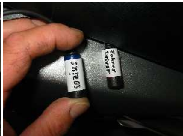
Hier die verkabelten angeklebten Mützen, die Stecker unter der Sitzbank habe ich vorsichtshalber nochmals entsprechend nach Fahrer und Sozius beschriftet.
