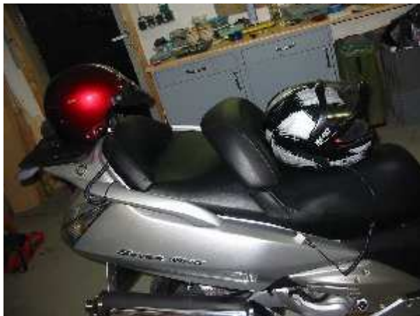
Hier die verkabelten angeklebten Mützen, die Stecker unter der Sitzbank habe ich vorsichtshalber nochmals entsprechend nach Fahrer und Sozius beschriftet.
